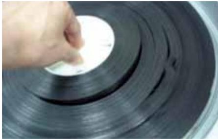
圖 1-28、捲片鬆散，易因拉力緊纏造成拉痕
