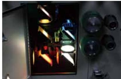
圖 3-39、印片機上的紙帶讀取儀器 (讀取尺數與光號)
