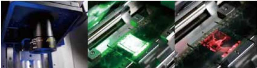
圖 2-19ABC、ARRIFILM SACN 使用低熱能三色光源，較不容易對膠片造成不良影響
