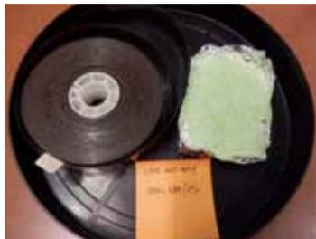
圖 3-5、《戀愛與義務》沾黏部分使用矽膠 (silica gel) 加濕處理
