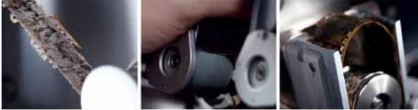
圖 2-13、齒孔嚴重破損的膠片
