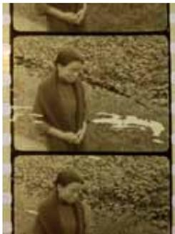
圖 3-6、《戀愛與義務》沾黏部分展開時，藥膜脫落的情形
