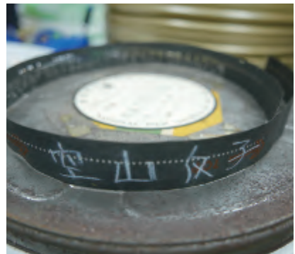
圖 8：給印片機輸入光號的紙帶。
