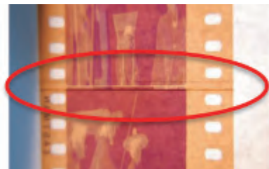
圖 21：實體膠片的膠水接頭。
