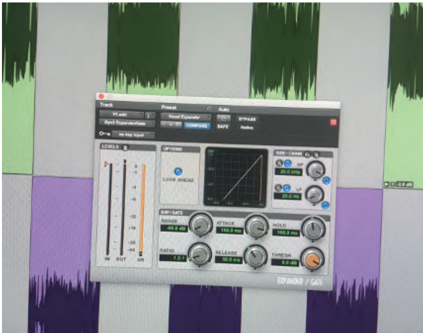
圖 52：使用 Pro Tools 中的 Dyn3 Expander 套件做最後的動態範圍延伸。
